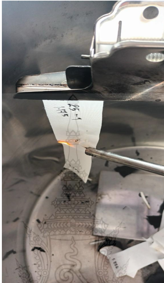
ภาพที่ 3.4 การทดสอบการไหม้ไฟโดยวิธีหาค่าร้อยละของเถ้าที่เหลือ (% Char yield)
