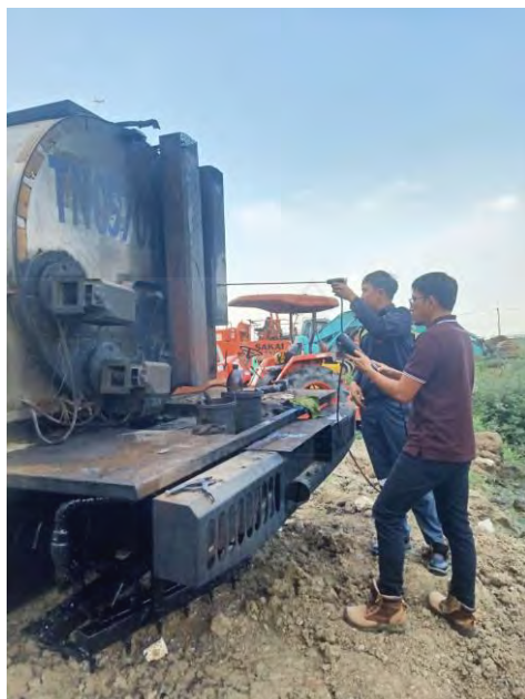
รูปที่ ก.9 วัดก๊าซไอเสียเตาเผาและบันทึกผลการทดสอบ
