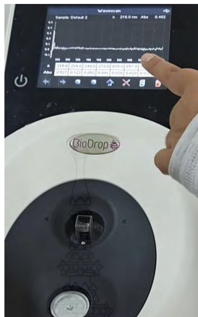
ภาพที่ 3.40 การวัดปริมาณไอโซนด้วยเครื่องสเปกโตรโฟโตมิเตอร์โดยการนำตัวอย่างน้ำกลั่นที่ผ่านการพ่นก๊าซไอโซนมาบรรจุในคิวเวท แล้วนำมาใส่ในช่องทดสอบเพื่อวัดค่าการดูดกลืนของแสง
