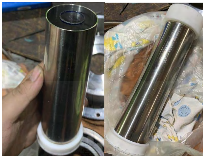
ภาพที่ 3.32 เทฟลอนที่ผ่านการกลึงเสร็จเรียบร้อยแล้วถูกนำมาประกอบเข้ากันทั้ง 2 ด้าน
