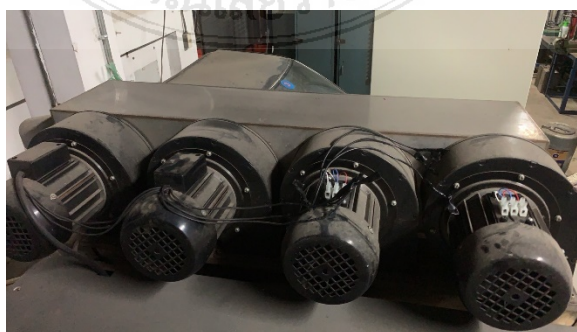
รูปที่ 3.12 การลดกำลังลมด้วยการตัดการทำงานของมอเตอร์พัดลม
