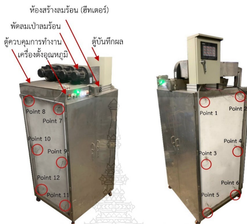
รูปที่ 3.6 ตู้อบลมร้อนและตำแหน่งการติดตั้งอุปกรณ์ต่างๆ
