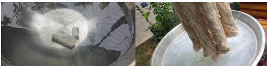
ภาพที่ 3.8 กระบวนการต้มทำความสะอาดเส้นด้ายฝ้าย
