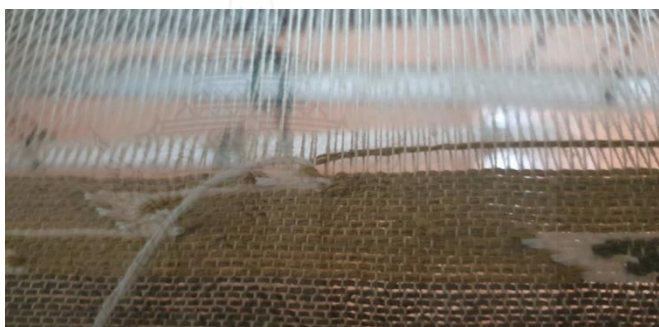
ภาพที่ 3.37 เส้นด้ายฝ้ายเกาะกันในเทคนิคการเกาะ ล้วง
