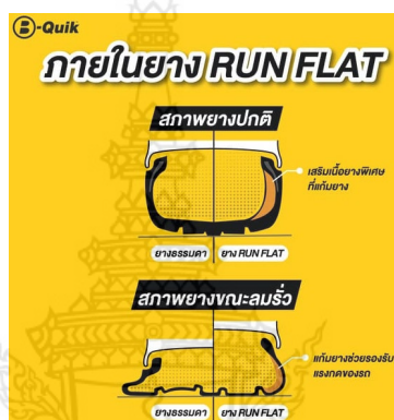
รูปที่ 1.1 โครงสร้างภายในของยางธรรมดาและยางรันแฟลท [1]
