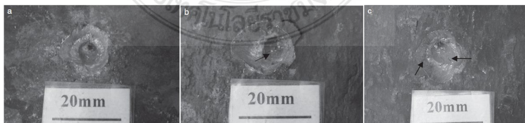
รูปที่ 2.11 มุมมองด้านบนของรูเจาะภายหลังการชนกับกระสุน 7.62 AP รอยแตกขนาดเล็กชี้ให้เห็นโดยเครื่องหมายลูกศรในการทำ Tempering time 24 และ 48 ชั่วโมง (a) Tempering time 2 ชั่วโมง (b) Tempering time 24 ชั่วโมง และ (c) Tempering time 48 ชั่วโมง [13]
