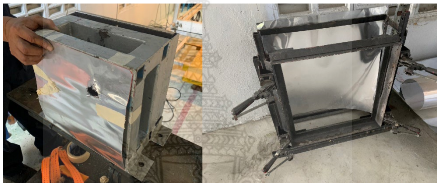
รูปที่ 4.12 การจัดเตรียมกระเบาะวัสดุหนุ่นเพื่อรองรับแผ่นเกราะที่จะยิงและการติดตั้งแผ่นพิสูจน์
