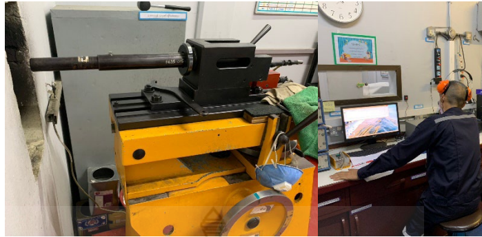
รูปที่ 4.11 เครื่องยิงกระสุนและเครื่องคอมพิวเตอร์สำหรับบันทึกผลและควบคุม
