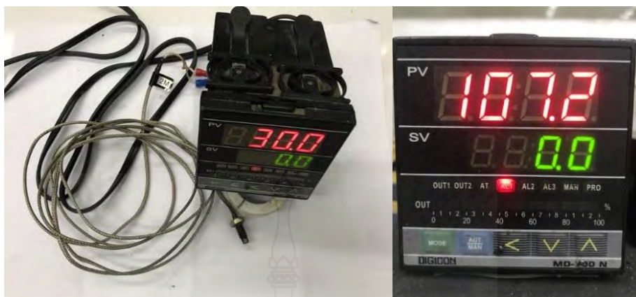
รูปที่ 3.13 อุปกรณ์ตรวจวัดอุณหภูมิไอเสีย
