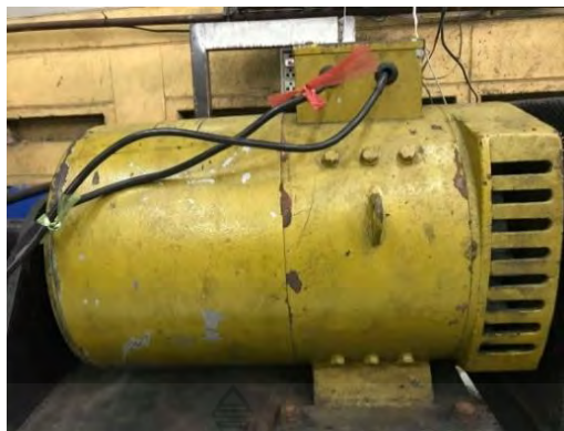
รูปที่ 3.3 เครื่องกำเนิดไฟฟ้า (Generator) ขนาด 7 กิโลวัตต์
