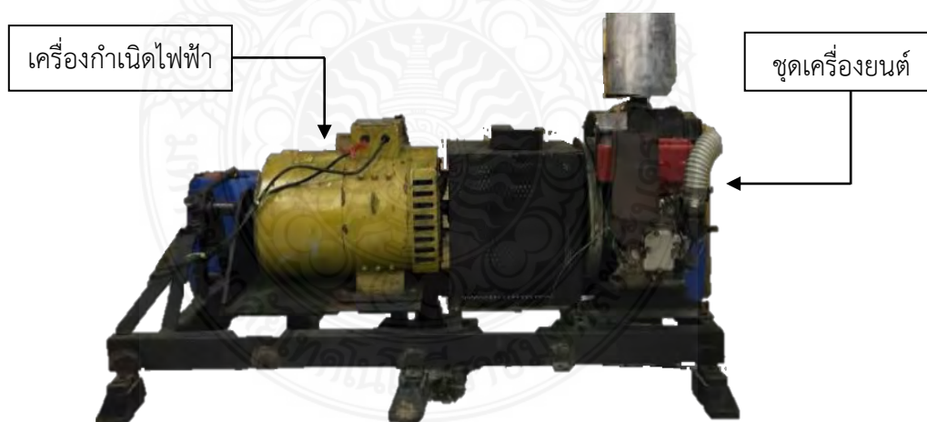
รูปที่ 3.2 ชุดทดสอบสมรรถนะเครื่องยนต์
