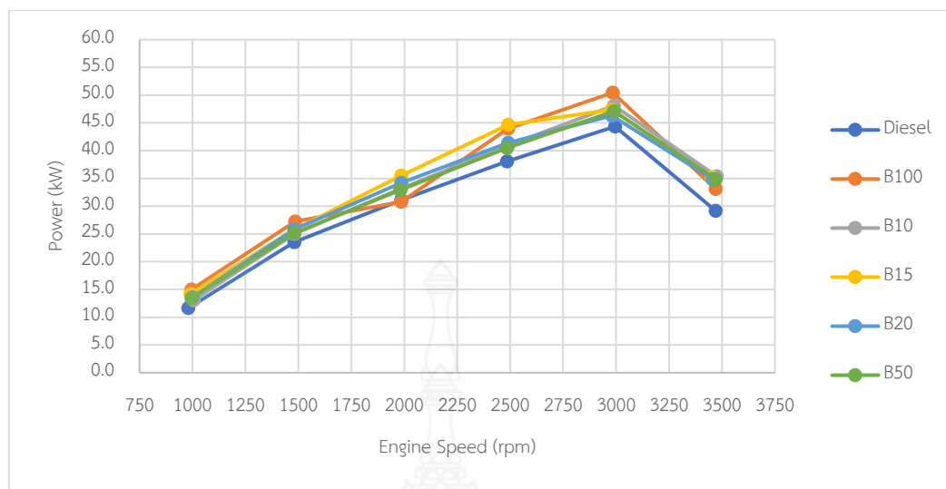
ภาพที่ 4.14 การเปรียบเทียบกำลังกับความเร็วรอบของเครื่องยนต์
