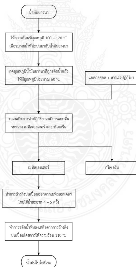
รูปที่ 3.6 แผนผังแสดงขั้นตอนการผลิตไบโอดีเซล
