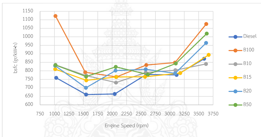
รูปที่ 4.21 การเปรียบเทียบอัตราการสิ้นเปลืองเชื้อเพลิงจำเพาะเบรกกับความเร็วรอบของเครื่องยนต์
