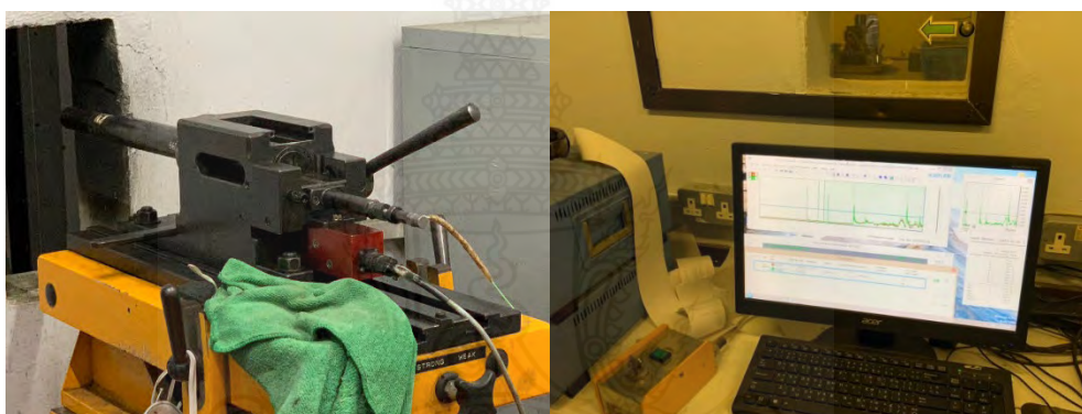
รูปที่ 4.2 เครื่องยิงกระสุนและเครื่องคอมพิวเตอร์สำหรับบันทึกผลและควบคุม
