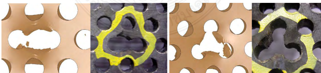
รูปที่ 2.4 เปรียบเทียบผลการเจาะทะลุเกราะด้วยระเบียบวิธีไฟไนต์เอลิเมนต์และการทดลอง [7]
