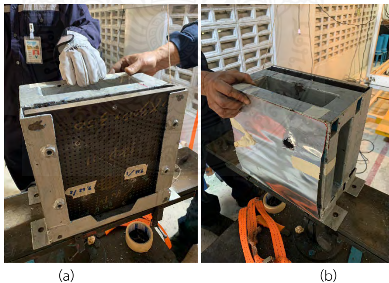
รูปที่ 4.3 การจัดเตรียม a) กระดาษวัสดุหนุ่นเพื่อรองรับแผ่นเกราะที่จะยิงตามมาตรฐาน NIJ และ b) แผ่นพิสูจน์ถูกเจาะทะลุ
