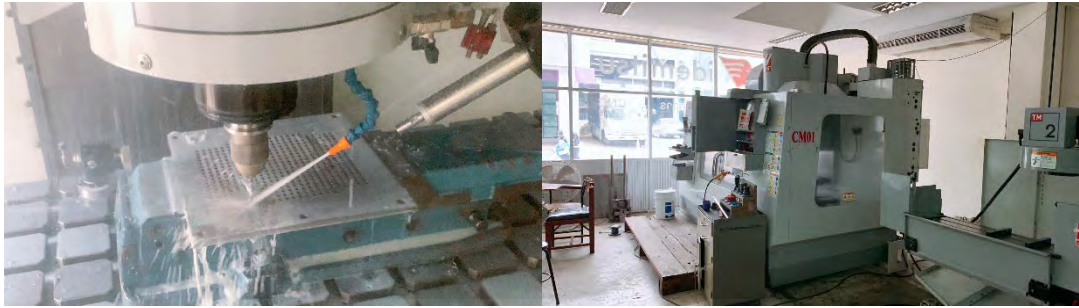
รูปที่ 3.29 การขึ้นรูปแผ่นเกราะพรุนด้วย CNC
