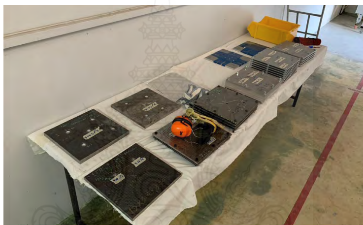
รูปที่ 4.5 แผ่นเกราะกันกระสุนสำหรับการทดสอบ
