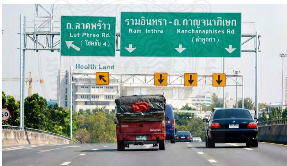
รูปที่ 1.2 ป้ายจราจรแขวนสูงแบบคร่อมผิวจราจรที่ใช้บนทางพิเศษ [3]
