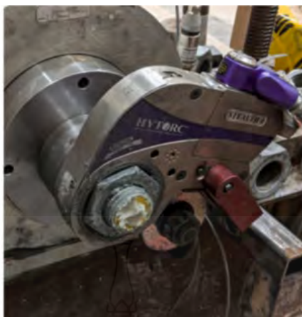
รูปที่ 2.21 การทดสอบแบบ Skidmore-Wilhelm [12]
