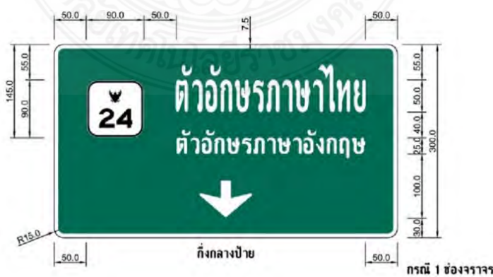
รูปที่ 2.4 แบบมาตรฐานป้ายแนะนำทางแบบคร่อมผิวจราจร 1 ช่องทาง [1]
