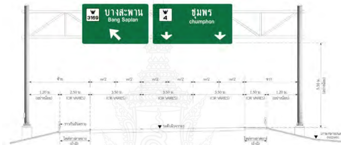
รูปที่ 2.7 แบบข้อกำหนดระยะของเสาป้ายแนะนำทางแบบคร่อมผิวจราจร [1]
