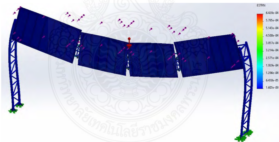
รูปที่ 4.3 ผลการคำนวณค่าความเครียดสูงสุดที่ความเร็ว 90 กม./ชม. ทิศทางเดียวกัน
