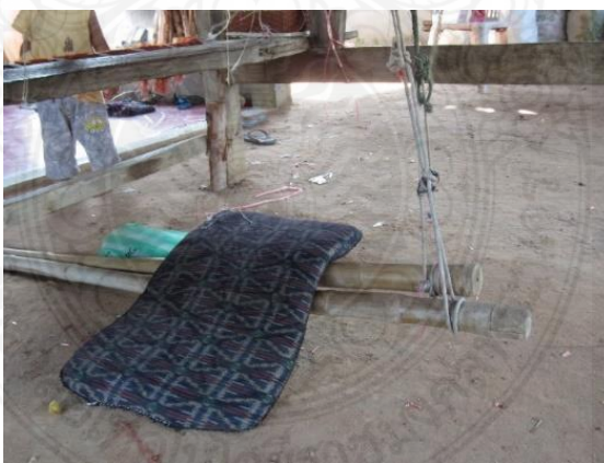
ภาพที่ 2.26 ตีนฟืม หรือตีนเหยียบ หรือคานเหยียบ
