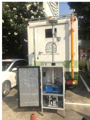
ภาพ 2.10 เครื่อง Light Scattering ของกรมควบคุมมลพิษ ที่มา: กรมควบคุมมลพิษ (2564)
