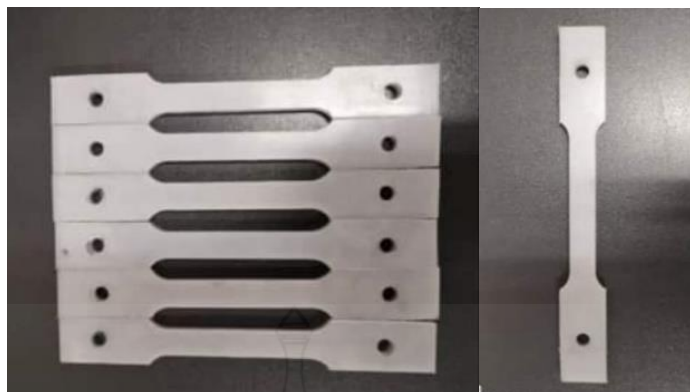
รูปที่ 3.15 ชิ้นทดสอบที่เตรียมสำหรับการทดสอบแรงดึง
