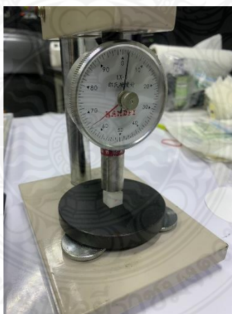
รูปที่ 3.12 เครื่องทดสอบความแข็ง Durometer แบบ Shore D และลักษณะการทดสอบความแข็ง
