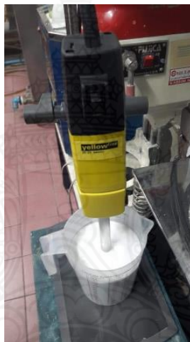
รูปที่ 3.6 การผสมผงอนุภาค Al_2O_3 + UHMWPE แล้วปั่นผสมด้วยเครื่อง High speed homogenizer
