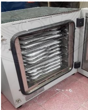
รูปที่ 3.7 เทพ UHMWPE ที่ปั่นผสมกับผงอนุภาค Al_2O_3 ใสในถาดและนำไปเข้าตู้อบลมร้อน
