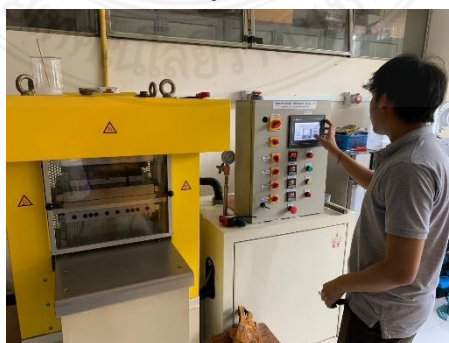
รูปที่ 3.10 แสดงเครื่องอัดเข้าพอลิเมอร์สำหรับขึ้นรูปชิ้นทดสอบวัสดุก้อน ผงอนุภาค UHMWPE ผสมกับผงอนุภาค Al_2O_3
