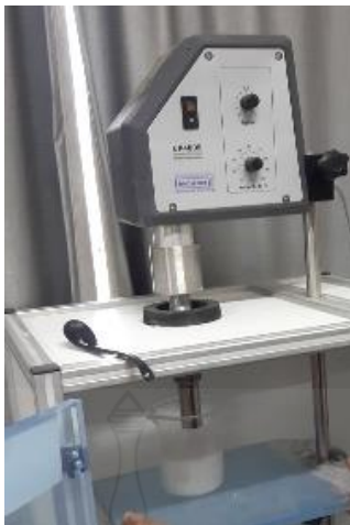
รูปที่ 3.5 การละลายผงอนุภาค Al_2O_3 ในเมทิลแอลกอฮอล์ด้วยเครื่อง Ultrasonic disperser
