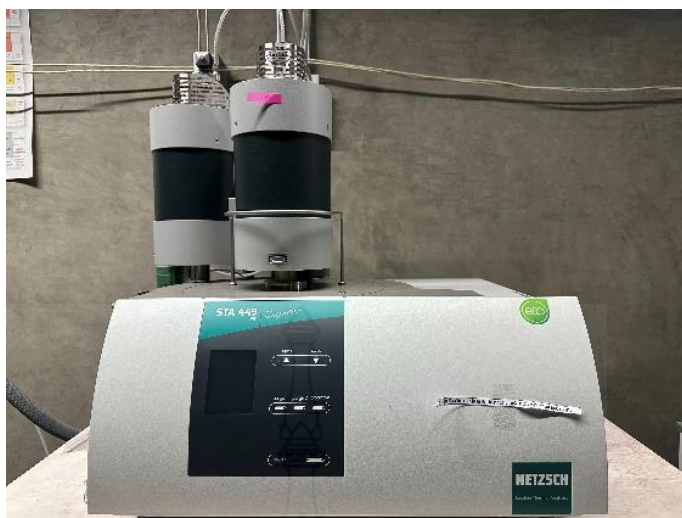
รูปที่ 3.19 เครื่องทดสอบสมบัติทางความร้อน ยี่ห้อ NETZSCH STA 449 JUPITER
