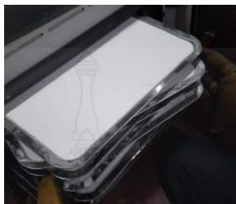
รูปที่ 3.8 ผง UHMWPE ที่มีส่วนผสมของ Al_2O_3 ผสมอยู่ภายในหลังจากที่ทำการอบแห้งแล้ว
