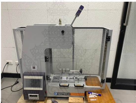
รูปที่ 3.17 เครื่องทดสอบแรงกระแทกชิ้นงานพอลิเมอร์ แบบ Izod ตามมาตรฐาน ASTM D256
