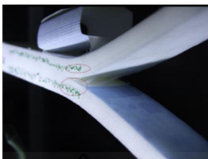
รูปที่ 2.24 การแยกตัวระหว่างการทดสอบความเป็นไปได้ของชิ้นงานดัดแปลง DCB ที่มีความกว้าง 20 mm ของโพลีในอัตราการเคลื่อนที่ 0.5 mm/min [56]
