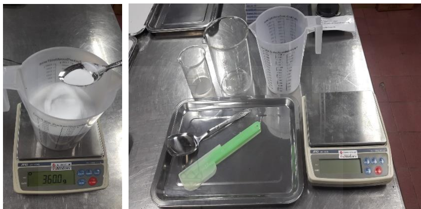
รูปที่ 3.3 อุปกรณ์ในการเตรียมผงและการชั่งน้ำหนักผง UHMWPE ด้วยเครื่องชั่งละเอียด 0.1 mg
