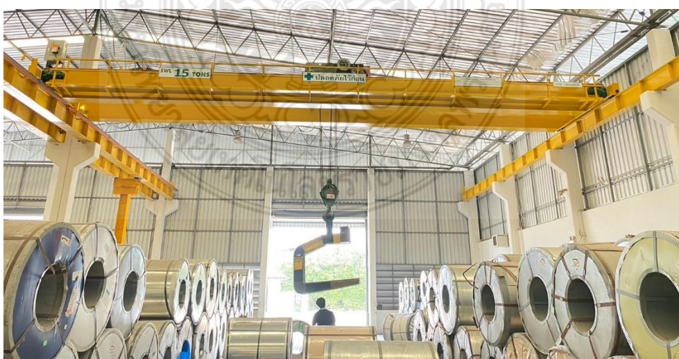
ภาพที่ 2-2 เครนคานคู่ (Double Girder Overhead Cranes) (ที่มา : บริษัท เค.ซี.ไอ.เอ็นจีเนียริง จำกัด)
