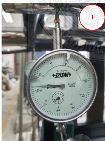
รูปที่ 4.9 แรงกระทำที่ 1000 N ค่าจาก Dial Gauge เท่ากับ 8.83, 3.10 และ 2.12 ตามลำดับ
