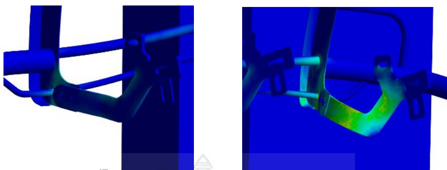
รูปที่ 4.37 ผลการจำลองแสดงค่า Equivalent Elastic Strain แรงกระทำเทียบเท่าน้ำหนักของ รถบรรทุกขนาดเล็กเท่ากับ 18000 N กระทำบริเวณกันชนรถยนต์บริเวณ ครึ่งขวาด้านหน้าด้านหน้า (ต่อ)
