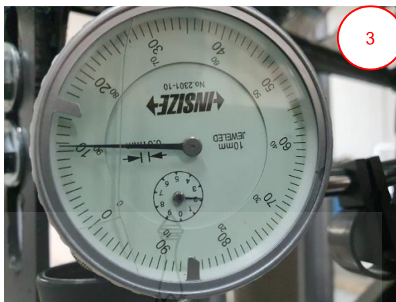
รูปที่ 4.9 แรงกระทำที่ 1000 N ค่าจาก Dial Gauge เท่ากับ 8.83, 3.10 และ 2.12 ตามลำดับ (ต่อ)
