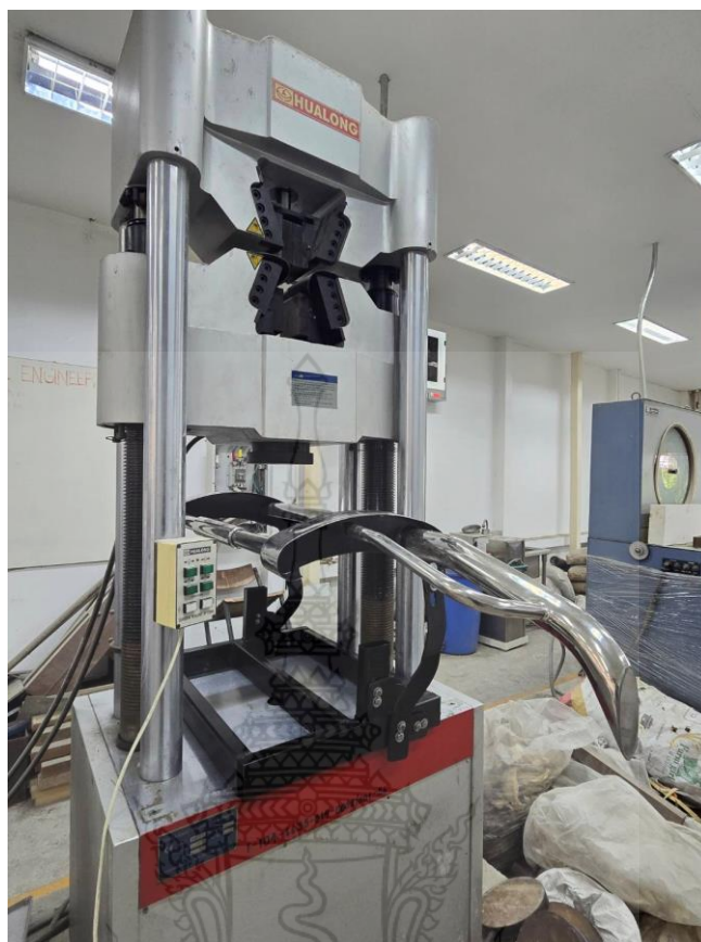
รูปที่ 3.44 ติดตั้งกันชนรถยนต์เข้ากับเครื่องทดสอบ
