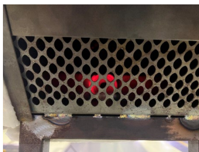
รูปที่ 3.8 ด้านท้ายเครื่องอบแห้งแสดงตอนแท่ง Heater ทำงาน
