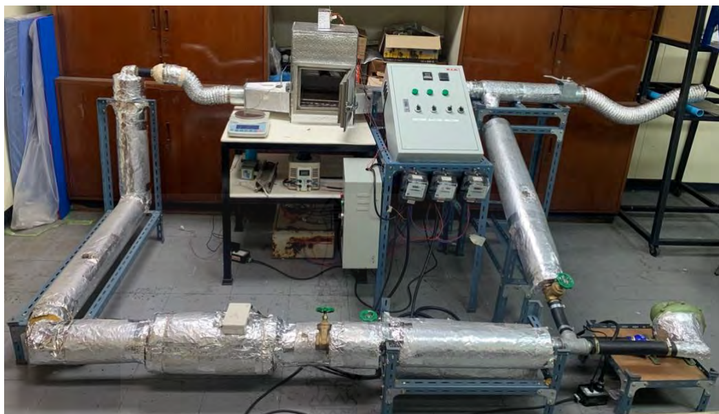
ภาพที่ 3.5 เครื่องอบแห้งมะม่วงน้ำดอกไม้วัดด้วยรังสีอินฟราเรดร่วมกับลมร้อน
