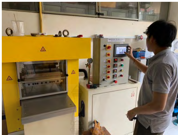
รูปที่ 3.6 เครื่องอัดขึ้นรูปขึ้นทดสอบ [2]
