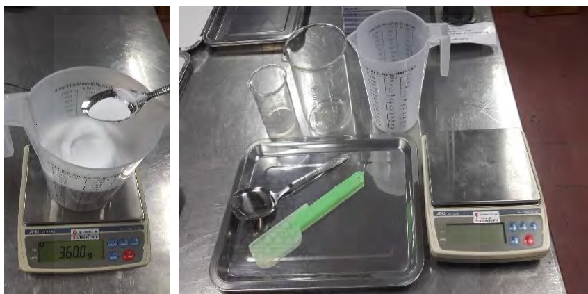
รูปที่ 3.2 อุปกรณ์ในการเตรียมผงและการชั่งน้ำหนักผงพอลิเอทิลีนน้ำหนักโมเลกุลสูง UHMWPE ด้วยเครื่องชั่งละเอียด 0.1 mg
