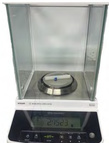
รูปที่ 3.14 เครื่องชั่งน้ำหนัก Shimadzu digital รุ่น ATX224 ความละเอียด 0.1 mg (0.0001 g) สำหรับชั่งตวงหาน้ำหนักที่สูญเสียของขึ้นทดสอบ
