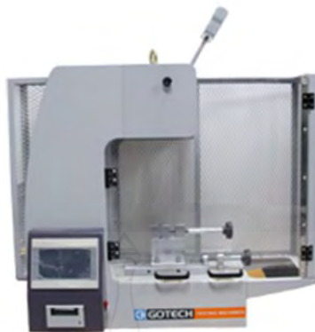
รูปที่ 2.15 เครื่องทดสอบแรงกระแทก GOTECH testing Machines Inc. โมเดล GT-7045-HML แบบ Izod ตามมาตรฐาน ASTM E 23
