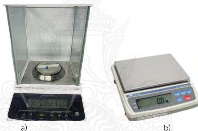
รูปที่ 2.22 เครื่องชั่งน้ำหนัก a) เครื่องชั่ง 4 ตำแหน่ง ยี่ห้อ Shimadza รุ่น ATX224 R สำหรับชั่งตวงหาน้ำหนักที่สูญเสียของชิ้นทดสอบ และ b) เครื่องชั่งน้ำหนักละเอียด 0.1 g ยี่ห้อ AND รุ่น EK-1200i
