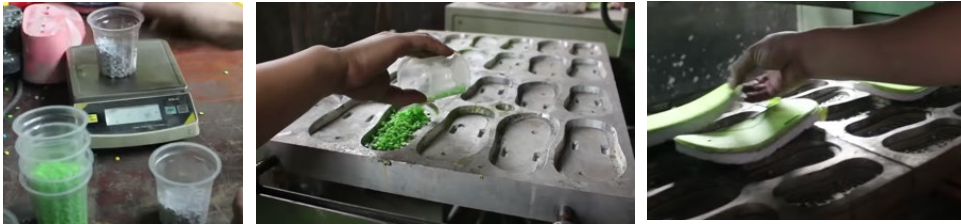
ภาพที่ 57 การผลิตพื้นชั้นกลาง (MIDSOLE) โดยวิธีการใช้เม็ดพลาสติก
