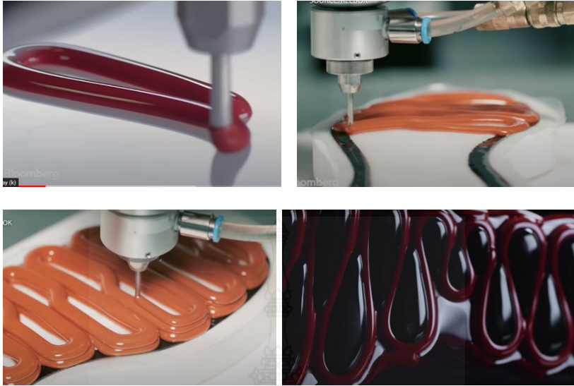
ภาพที่ 89 การฉีดพลาสติก TPU พื้นล่างรองเท้า
