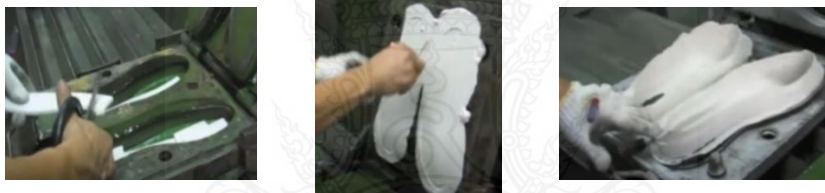
ภาพที่ 58 การผลิตพื้นชั้นกลาง (MIDSOLE) โดยวิธีการใช้โฟมยาง
