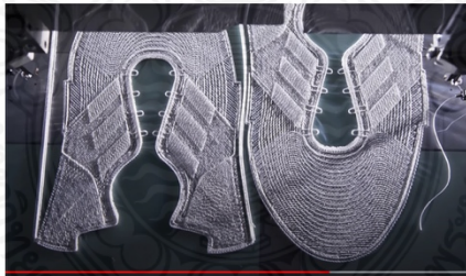
ภาพที่ 81 การทอหน้าผ้าด้วยระบบคอมพิวเตอร์
