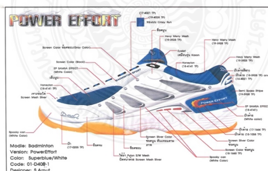
ภาพที่ 72 กำหนดวัสดุบนรองเท้าเพื่อสร้างต้นแบบทดสอบ
