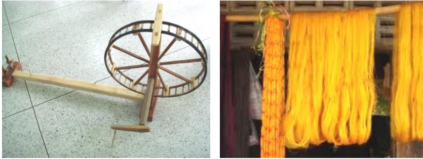
ภาพที่ 3.6 เครื่องทำเช็ดไหมหรือเหล่ง และเช็ดไหม
