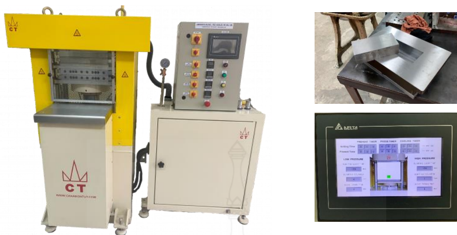
รูปที่ 3.6 แสดงเครื่องอัดเข้าพอลิเมอร์สำหรับขึ้นรูปขึ้นทดสอบวัสดุก่อนผงอนุภาคUHMWPE ผสมกับผงอนุภาคอลูมิเนียม (Al)
