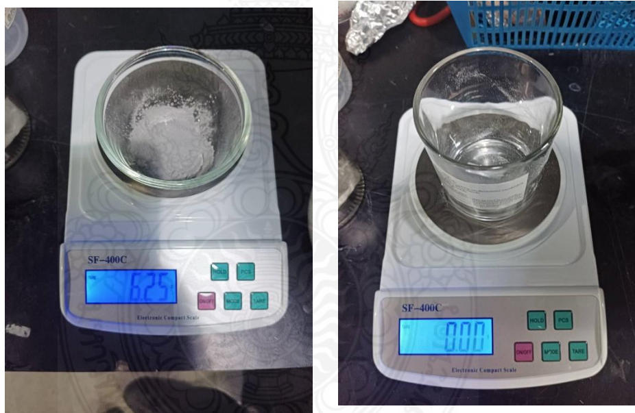
รูปที่ 3.3 แสดงการเตรียมอุปกรณ์และการชั่งน้ำหนักผง UHMWPE ด้วยเครื่องชั่งละเอียด 0.1 mg
