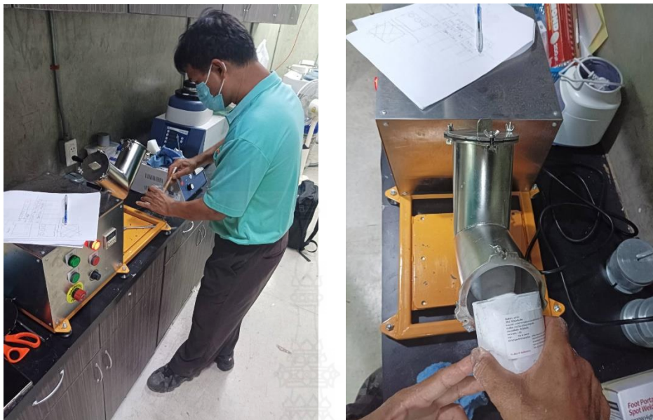
รูปที่ 3.4 แสดงการชั่งตวงน้ำหนักของ UHMWPE กับผงอลูมิเนียม (Al)
