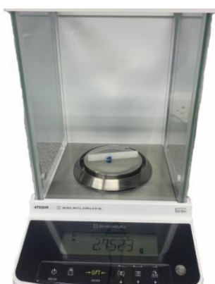
รูปที่ 3.15 เครื่องชั่งน้ำหนัก Shimadzu digital รุ่น ATX224 ความละเอียด 0.1 mg (0.0001 g) สำหรับชั่งตวงหาน้ำหนักที่สูญเสียของชิ้นทดสอบ
