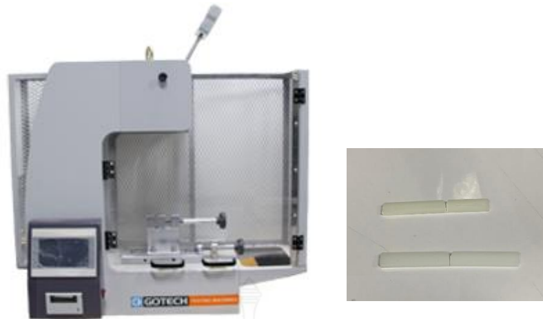
รูปที่ 3.13 เครื่องทดสอบแรงกระแทกชิ้นงานพอลิเมอร์ แบบ Izod ตามมาตรฐาน ASTM D256
