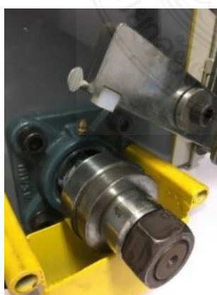
รูปที่ 3.14 เครื่องทดสอบการสึกหรอทดสอบแบบ Block on Ringตามมาตรฐาน ASTM G77 [60]
