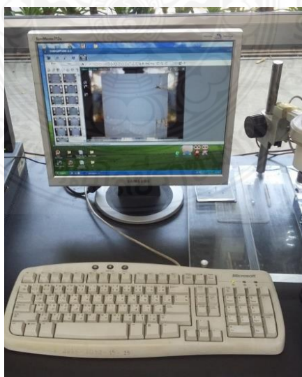
รูปที่ 3.16 ชุดอุปกรณ์บันทึกภาพรอยสึกหรอของชิ้นทดสอบ
