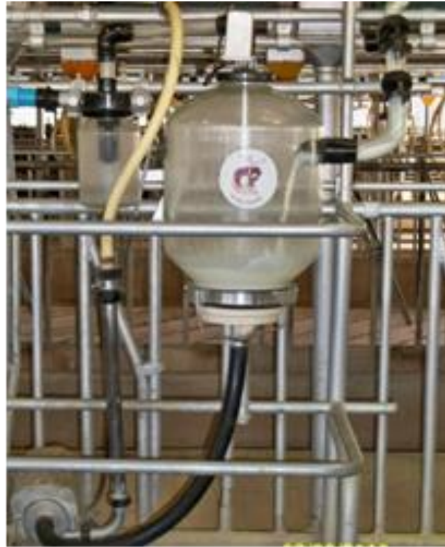
ภาพที่ 1 อุปกรณ์รวบรวมน้ำนมดิบที่รีดได้จากเต้านมโค ที่มา : ชมภูงูช (2557)
