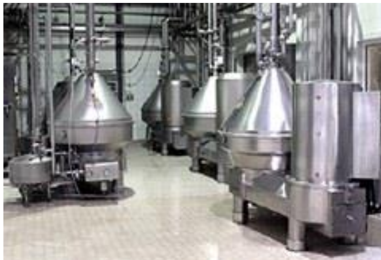
ภาพที่ 3 เครื่องแยกไขมันนมในโรงงาน ที่มา : Westfalia Separator, Inc. (1996)
